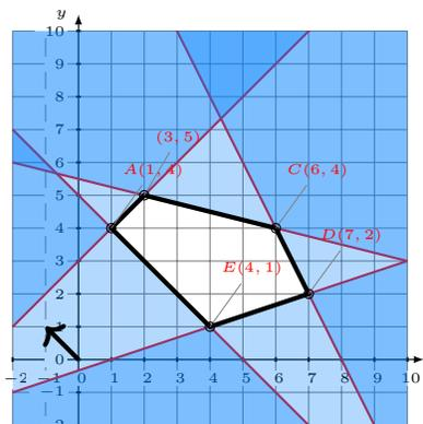
Los vértices respectivos son:  $A = (1, 4)$ ,  $B = (2, 5)$ ,  $C = (6, 4)$ ,  $D = (7, 2)$  y  $E = (4, 1)$ . Si utilizamos el método gráfico, obtenemos que el segmento AE es paralelo al vector de la función. Como buscamos el valor mínimo, todos los puntos comprendidos entre A y E sirven, es decir, hay infinitas soluciones.
